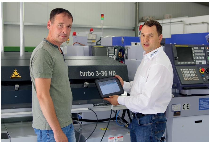
**Bild 6:** Ergonomisch und intuitiv bedienen: Die Steuerung ERGOlogic der Stangenmagazine von FMB orientiert sich an aktuellen, von Smartphones bekannten Verfahren und vereint das Parametrieren, Einrichten und Überwachen von Stangenlader und Hochdruck-Anlage (Bernd Braun, l. und Michael Büchele, Geschäftsführer SF-Systeme Büchele GmbH)
