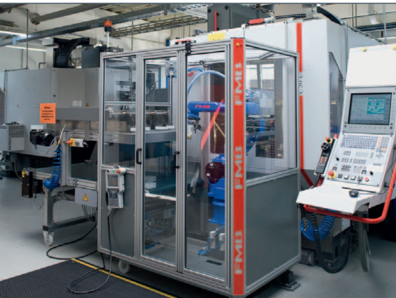
2 Kompakt und mobil: Bei Bedarf ist der Bearbeitungsraum frei zugänglich. Alternativ lässt sich die umhaute Automationszelle auch an anderen BAZ via Bodenanker präzise reproduzierbar andocken
