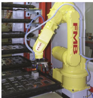
Das Handling der Werkstückträger innerhalb der Automationszelle erledigt ein integrierter Palettenwechsler
