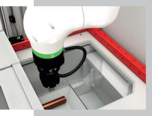
Die integrierte Kamera erkennt die Lage des Werkstücks und ermöglicht einen präzisen Griff des Roboters.
