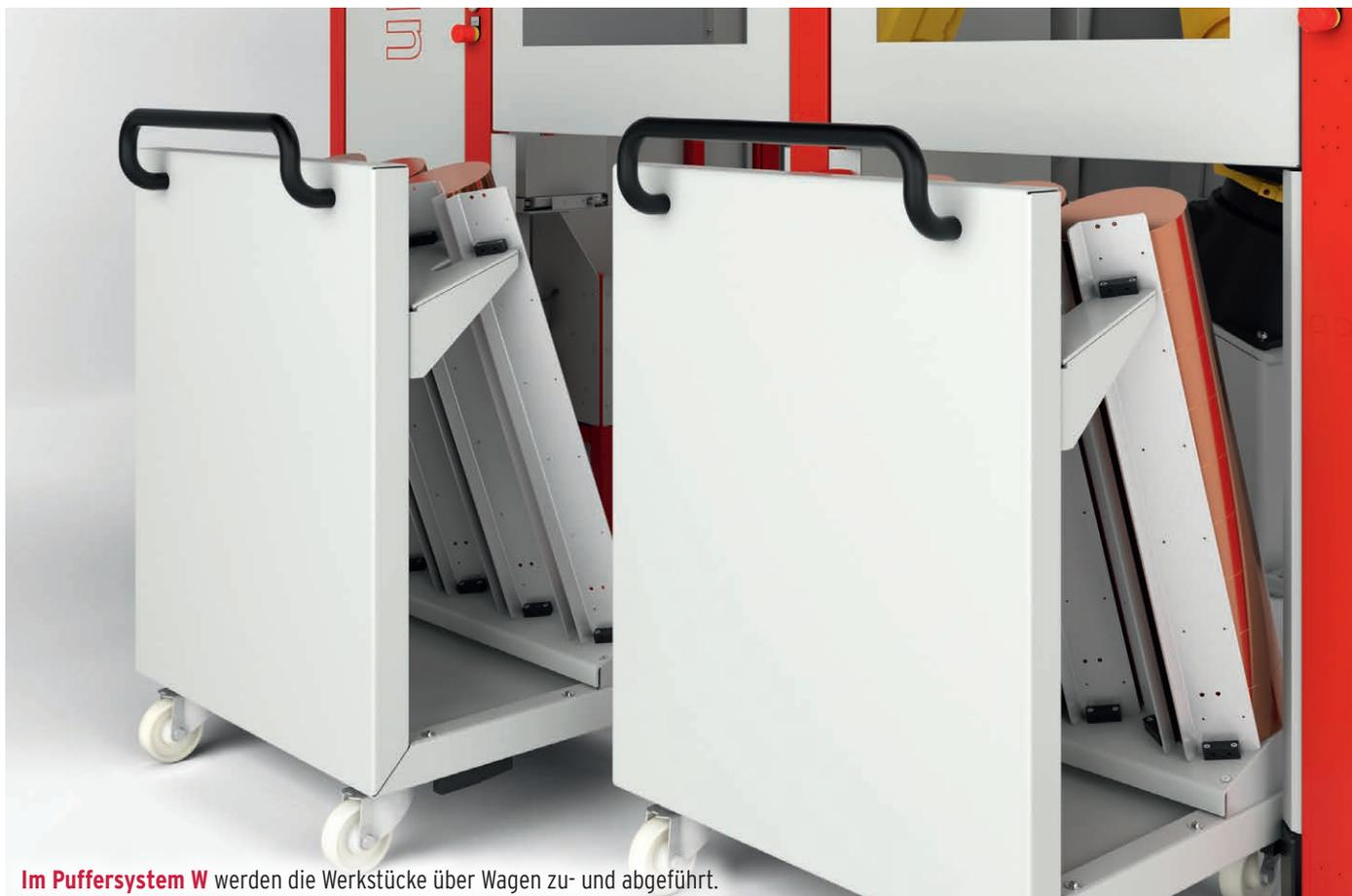
Im Puffersystem W werden die Werkstücke über Wagen zu- und abgeführt.
