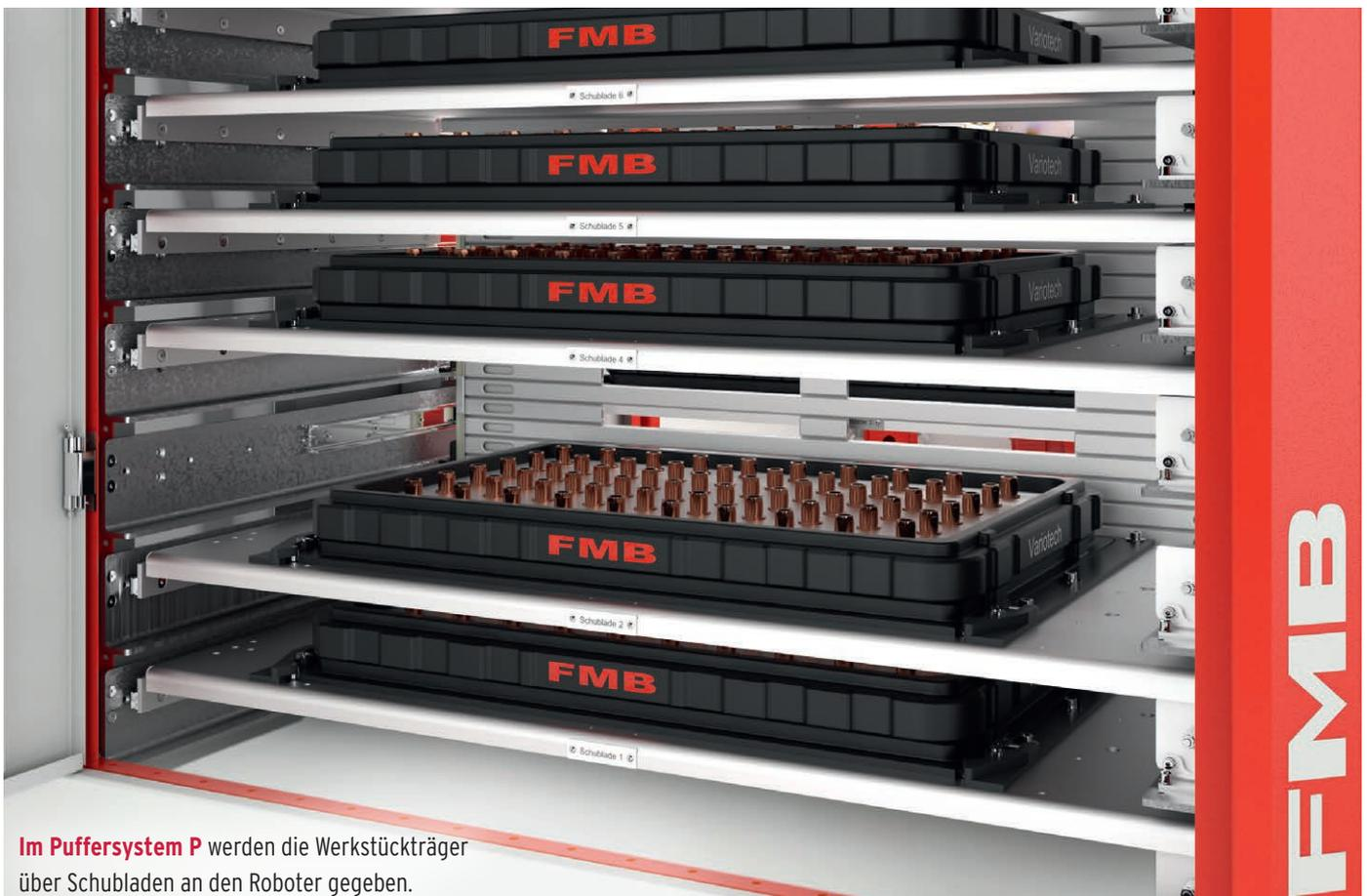
Im Puffersystem P werden die Werkstückträger über Schubladen an den Roboter gegeben.
