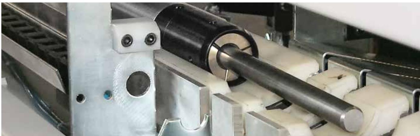
**Das Entladen** gehört auch zur vollständigen Automation von Drehmaschinen. FMB bietet dafür ebenfalls eine Lösung. Sie ist sorgfältig auf die Anforderungen aus der Praxis abgestimmt. Die fertig bearbeiteten Werkstücke werden durch die Gegenspindel gegriffen und aus dem Arbeitsraum der Drehmaschine herausgezogen. Fertigungsbetriebe profitieren damit von einem zuverlässigen, die Bauteile schonenden
