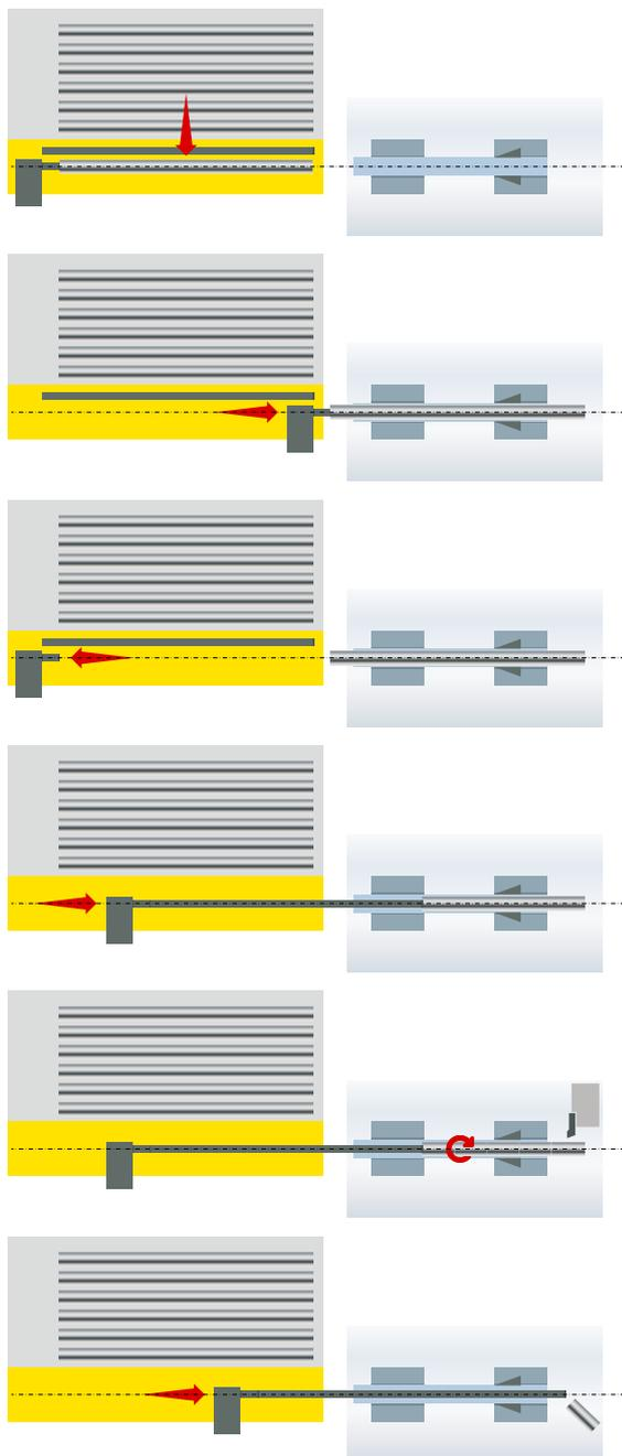
Die seitliche Materialauflage des Stangenladers bevorratet Kurzstangen aus Stahl, NE-Metallen oder Kunststoffen, eine Stange wird vereinzelt
