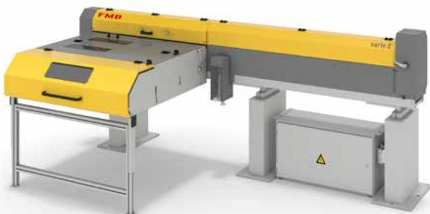
Das standardisierte Werkstückentladesystem vario E entnimmt fertig bearbeitete Werkstücke aus Drehmaschinen durch die Gegenspindel. Dazu fährt eine Entladestange den Greifer des Werkstückentladers in die hohle Gegenspindel. Nachdem der Greifer das Werkstück gespannt hat, zieht die Entladestange beides heraus. Auf einem seitlich angeordneten Magazin wird das Bauteil anschließend abgelegt. Den Greifer,
