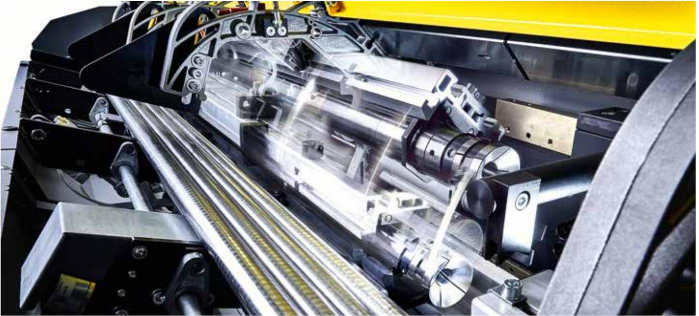
**Stangenlader** führen Halbzeuge in Form von Stangen mit unterschiedlichen Querschnitten Dreh- bzw. CNC-Drehmaschinen vollautomatisch zu. Wesentliche Unterschiede bestehen zwischen Einspindel- und Mehrspindeldrehautomaten. FMB bietet überwiegend für Einspindel-drehautomaten eine Vielzahl an Standardlösungen. Zudem gibt es von
