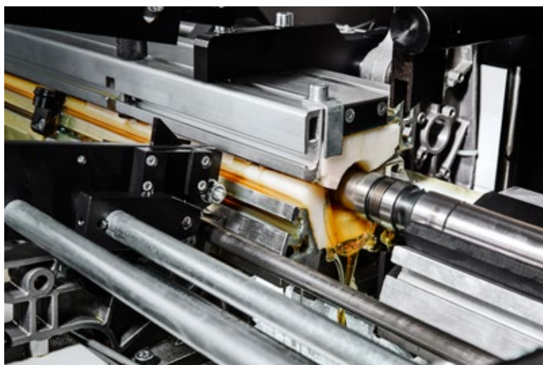
Optimal geführt Ölgefluteter Führungskanal mit hydrodynamischer Lagerwirkung
